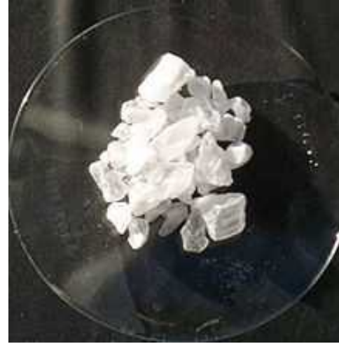
アルミニウムミョウバン \text{AlK}(\text{SO}_4)_2 \cdot 12\text{H}_2\text{O}
